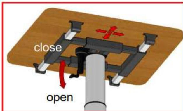
2. Rabattez le levier du système de verrouillage centralisé pour déplacer le plateau dans la position souhaitée – appuyez le levier vers le plateau afin de sécuriser le plateau en position
